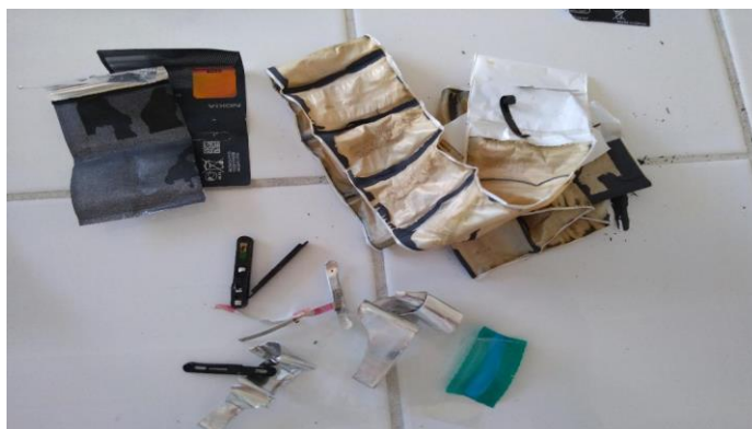
Figura 3.3. Carcasă, elemente din masa plastică (elemente susținere, separatori) provenite din dezmembrarea unei baterii LCO.
