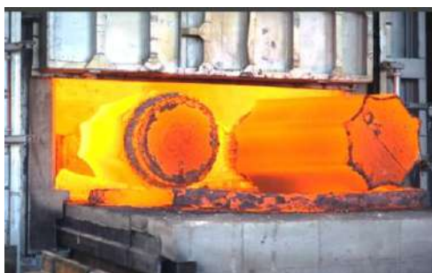
Figura 3.2. Cuptor de încălzire a lingoului semifabricatul forjat 12CrMo9-10 .
