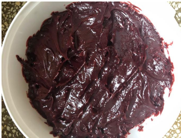
Figura 13. Unsoare fabricata experimental din uleiuri uzate (varianta 4)
