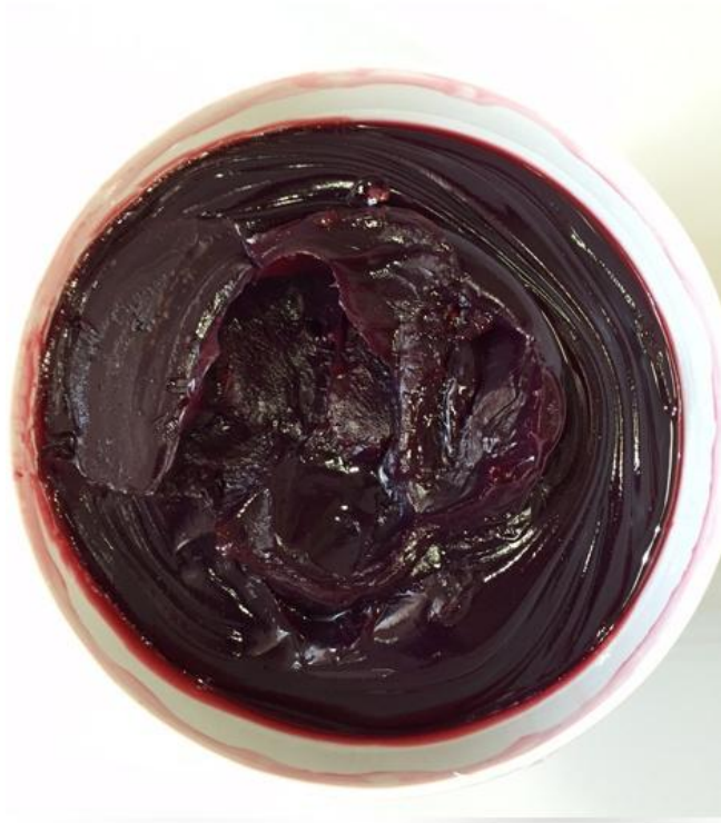
Figura 12 Unsoare fabricata experimental din uleiuri uzate (varianta1)
